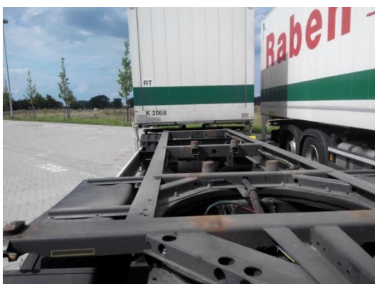
Ustawienie pojazdu (podwozia) do wjazdu pod kontener.
