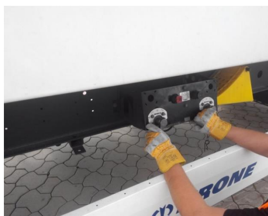
Podnoszenie i opuszczanie podwozia
