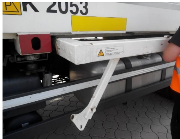
Odpięcie zastrzału z nogi podporowej.
