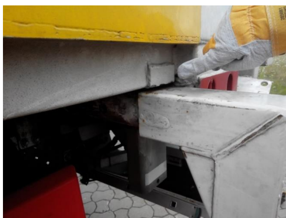
Prawidłowo przygotowana noga do postawienia kontenera (kontener musi się opierać na powierzchni płaskiej nogi podporowej).
