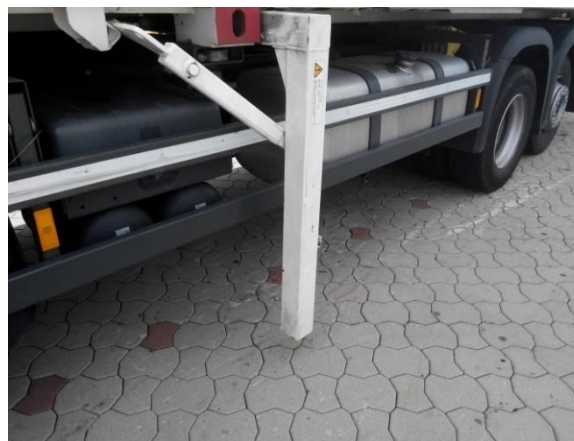
Sprawna, prosta rozłożona noga podporowa kontenera.
