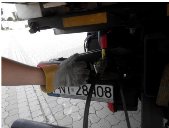
Wypięcie przewodu sterującego układem hamulcowym (żółty)
