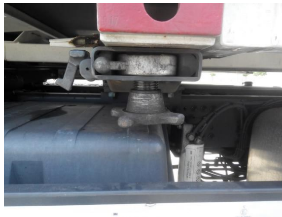
Odbezpieczona śruba kontenera (odblokowany bezpiecznik) i poluzowana kluczem.
