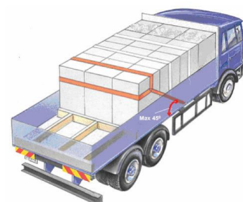
Mocowanie szpringowe za pomocą zawiesia.
