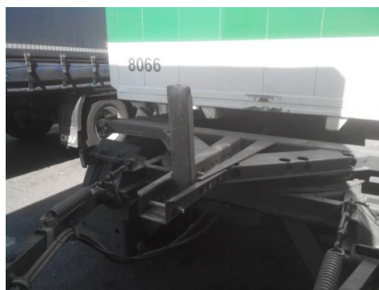
Pamiętaj! Podczas cofania z przyczepą nie przekraczaj linii odbojnika (zderzaka oporowego), grozi zgięciem dyszla.
