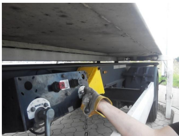
Regulacja wysokości podwozia (kontrola rolek centrujących).
