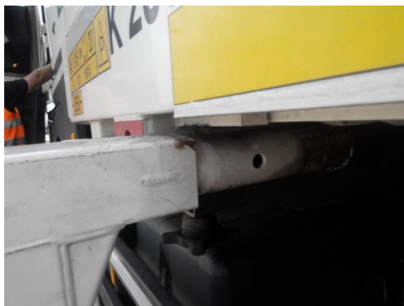
Nieprawidłowo rozłożona noga podporowa (zbyt mocno wyciągnięta).
