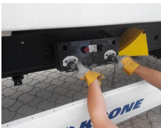
Podnoszenie i opuszczanie podwozia
