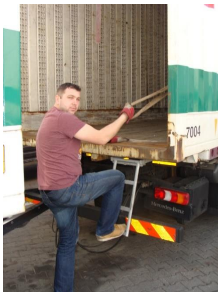
Bezpieczne wchodzenie do i schodzenie z kontenera.
