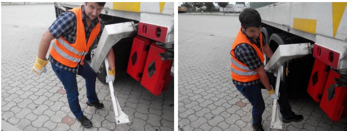
Podtrzymywanie nogi podporowej z zastrzałem podczas składania/rozkładania (zachowaj ostrożność - ryzyko urazu).
