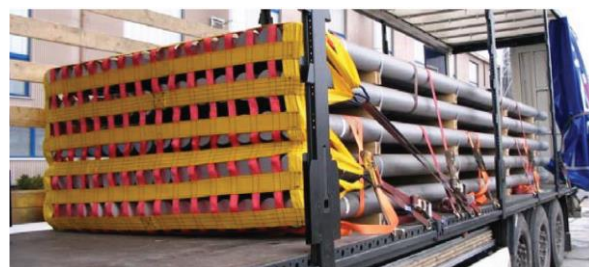
Zabezpieczenie za pomocą sieci i mocowania za pomocą odciągów prostych dociskających ładunek w kierunku jazdy.
