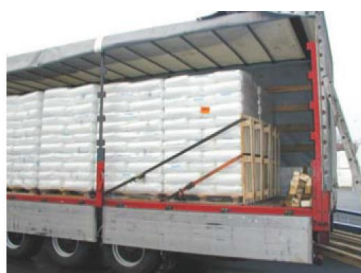
Mocowanie szpringowe za pomocą palet.
