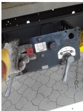
Wyciągnij czerwony przycisk – blokowanie hamulca podwozia.
