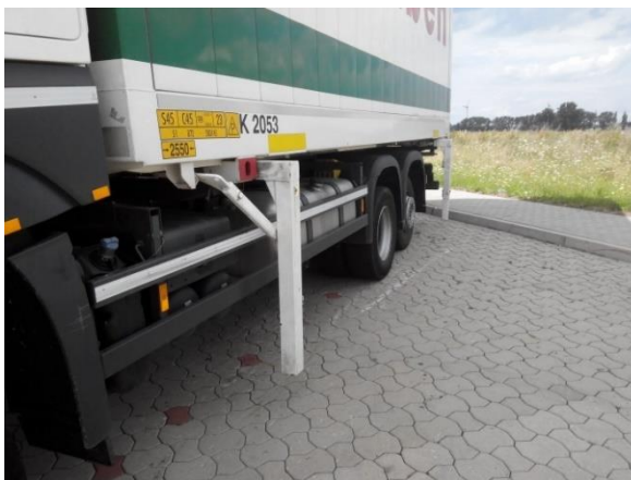
Sprawna, prosta rozłożona noga podporowa kontenera.
