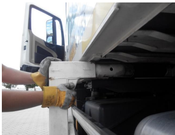
Prawidłowo rozłożona noga podporowa.
