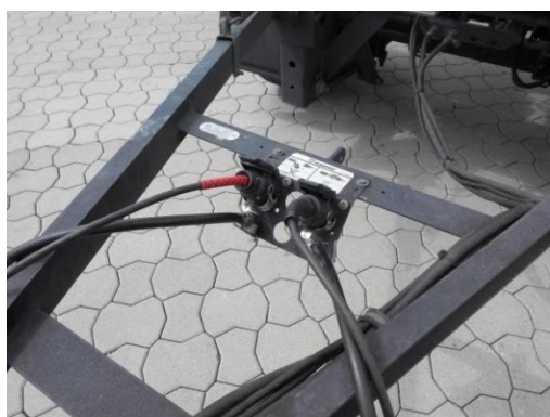
Odepnij przewody i zabezpiecz je w uchwytach na dyszlu.
