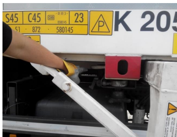
Zamknięcie bezpiecznika nogi podporowej.
