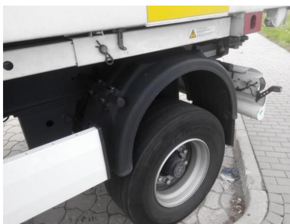
Zbyt wysoko podniesione podwozie. Wypoziomuj podwozie tak, aby kontener stał swobodnie i ostrożnie wyjedź spod niego.
